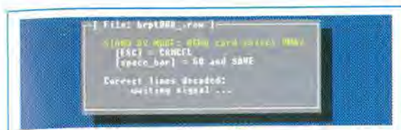
Fig.14 Quando sul monitor appare il menu principale visibile in fig.9, per entrare nella finestra di ricezione portate la fascia "rossa" sulla riga Receive HRPT e premete Enter. Fino a quando il ricevitore non capta un segnale, sotto "Correct lines decoded" apparirà la scritta waiting signal.
