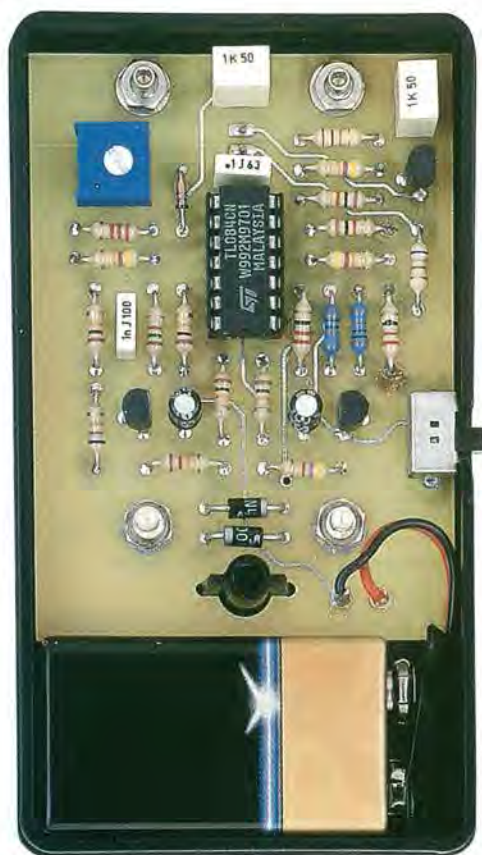
Fig.6 Fissato il circuito stampato all'interno del mobile, in basso noterete lo spazio destinato alla pila di alimentazione da 9 volt.
