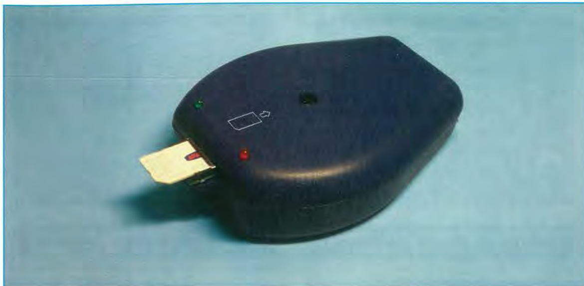
Fig.11 La Sim Card va infilata nella fessura del lettore rivolgendo le piste verso il basso. Se non infilerete correttamente la Sim Card, a video apparirà il messaggio di fig.15.
