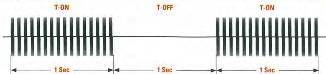
Fig.3 Il segnale sinusoidale di Kotz, che rimane attivo per 10 millisecondi e in pausa per 10 millisecondi (vedi fig.1), può essere programmato in base alle terapie consigliate dai fisioterapisti. Sul pannello del Generatore trovate, per il canale 1 e anche per il canale 2, dei pulsanti indicati T-ON (vedi P1-P3 in fig.5) e T-OFF (vedi P2-P4 sempre in fig.5), che vi permettono di variare il tempo in “secondi” di ON e OFF. In figura riportiamo l’esempio di un segnale regolato per un tempo di “1 secondo” sia per T-ON che per T-OFF.
