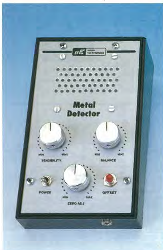
Fig.5 Ecco come si presenta il pannello frontale del cercametalli a Bobine Bilanciate. La prima manopola visibile in alto a sinistra serve per regolare la Sensibilità (vedi in fig.9 il potenziometro R33), mentre quella visibile in alto a destra serve per regolare il Bilanciamento (vedi in fig.9 il potenziometro R10). La terza manopola visibile in basso serve per regolare l'Azzerramento (vedi in fig.9 il potenziometro R26). Se doserete in modo perfetto queste tre manopole, riuscirete ad individuare oggetti interrati anche ad elevate profondità.
