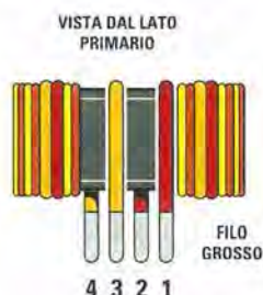
Fig.12. Guardando il trasformatore T1 dal lato del primario, cioè del filo più grosso, il filo 1 del primo avvolgimento è esterno al nucleo e il filo 2 è interno, il filo 3 del secondo avvolgimento è esterno e il filo 4 è interno. Notate la differenza dei colori dei fili.
