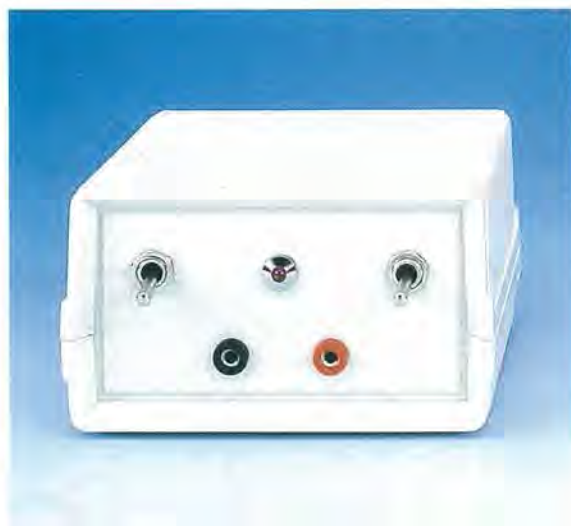
Fig.1 Ecco come si presenta il circuito in grado di far oscillare qualsiasi tipo di induttanza. La frequenza generata verrà applicata sull'ingresso di un frequenzimetro digitale come visibile nella foto di destra.
