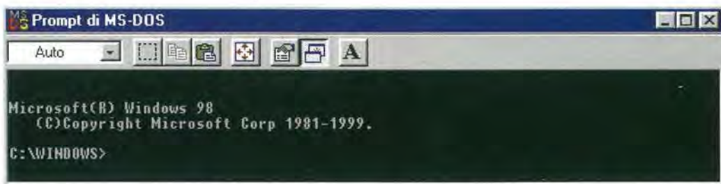
Fig.13 Se avete utilizzato il metodo errato riprodotto in fig.12, sullo schermo apparirà questa finestra di Windows e anche se in alto c'è scritto Prompt di MS-DOS, voi siete ancora dentro il sistema operativo Windows, come dimostrano le icone poste in alto.
