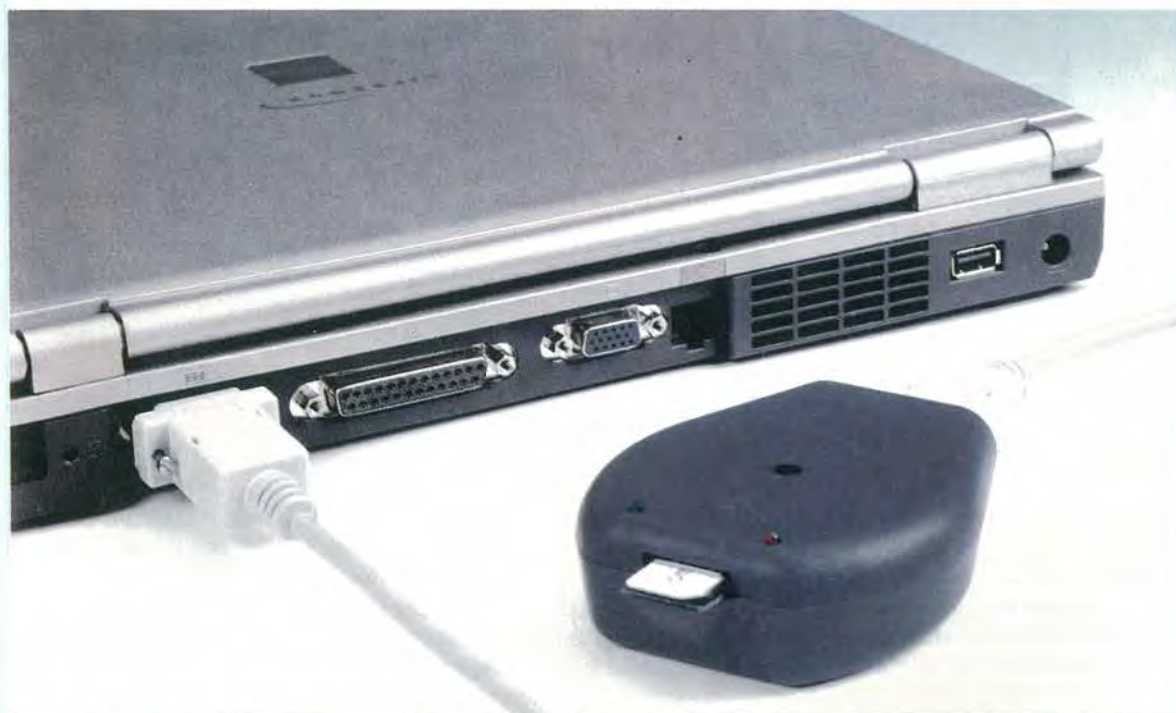
Fig.10 Il lettore GSMSIM, che vi forniamo già montato e completo della pila di alimentazione da 9 volt, va collegato ad una delle porte seriali del vostro computer.
