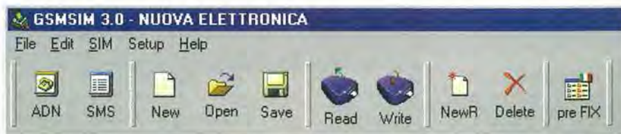
Fig.17 La barra degli strumenti del GSMSIM 3.0 include i tasti che consentono di eseguire le operazioni più comuni: con i tasti ADN e SMS si visualizza la rubrica telefonica e l'elenco dei messaggi SMS; i tasti New, Open e Save consentono di aprire e salvare i record di dati; i tasti Read e Write servono per leggere e scrivere nella Sim Card; i tasti NewR e Delete consentono di inserire un nuovo record o cancellare un record esistente; mentre il tasto pre Fix consente di eliminare lo zero dai prefissi dei cellulari.
